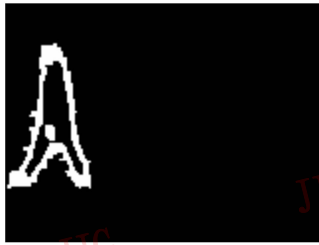
(h) 图(g)乘以图(e)后的图像 (除去了视频对象外部的边缘)
