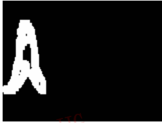
(e) 对图(d)进行二值膨胀后的图像
